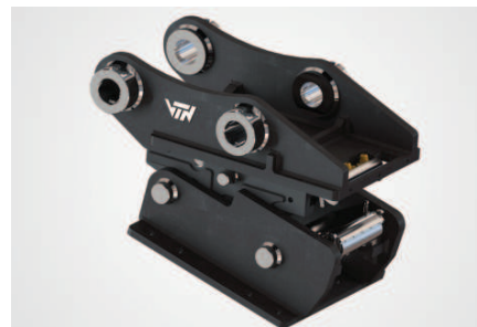
Plně automatické rychloupínače Link-o-Matic umožňují vyměnit v podstatě jakýkoli typ příslušenství přímo z kabiny. Jejich největšími výhodami je široká škála využití, rychlost výměny a bezpečnost práce.
