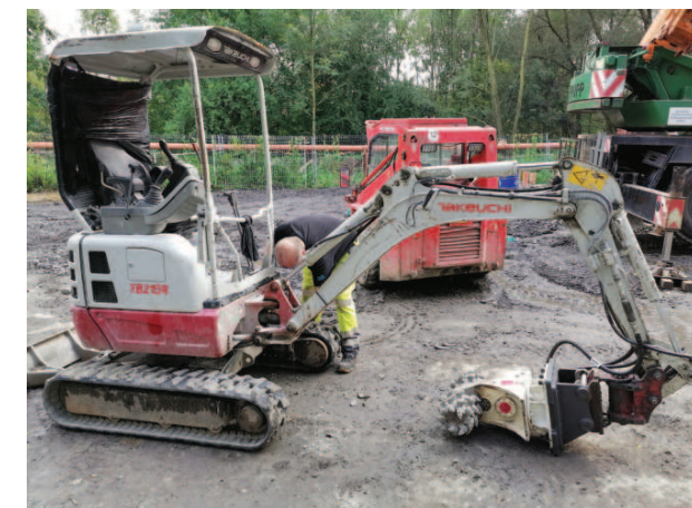
Minibagr Takeuchi o hmotnosti 1,7 t se skalní frézou čistí kanály na Ostravsku.
