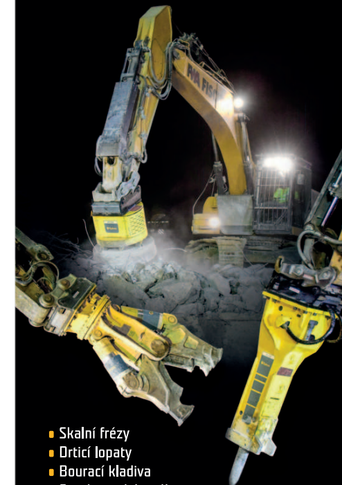
Plně automatické rychloupínače Link-o-Matic umožňují vyměnit v podstatě jakýkoli typ příslušenství přímo z kabiny. Jejich největšími výhodami je široká škála využití, rychlost výměny a bezpečnost práce.
